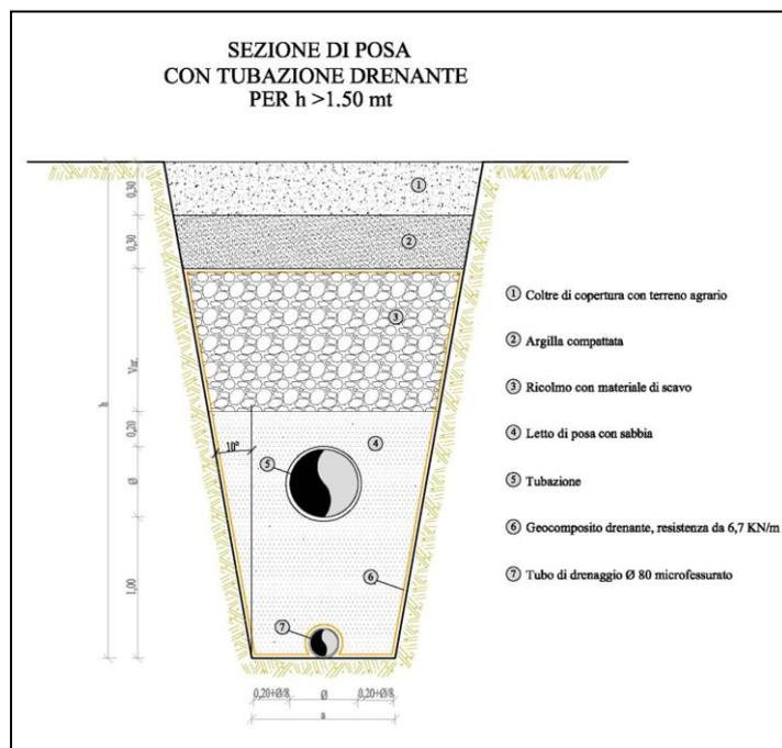
sezione di scavo di tipo trapezoidale con pareti inclinate di 10° sulla verticale; ricolmo e ripristino finale della sezione saranno realizzati analogamente alla precedente tipologia di sezione.
