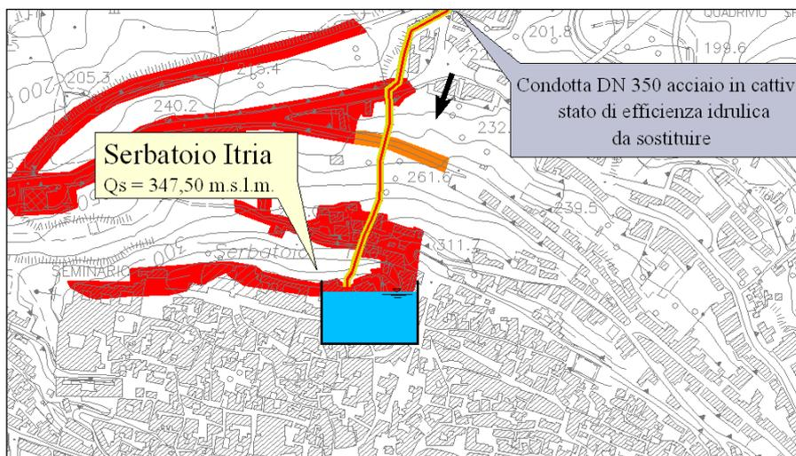
Nella zona evidenziata, la prevista sostituzione di un collettore di adduzione esistente attraverso un'area censita a rischio geomorfologico R4.
